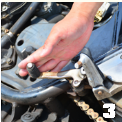
▲排入低速檔(1檔)。 ※扶起時可防止車輛滑行
