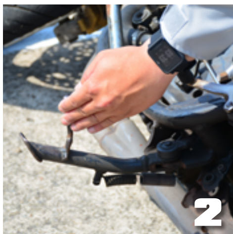
▲放出側腳架。 ※扶起時可利用側腳架架車
