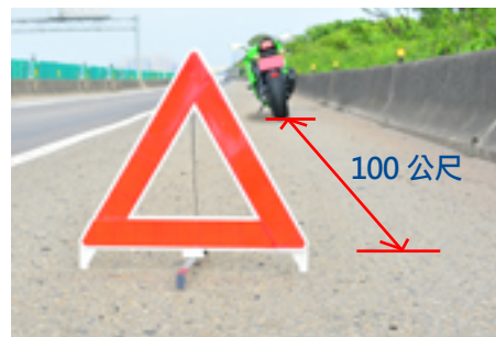
▲故障標誌設置之情況 (示意照片)
